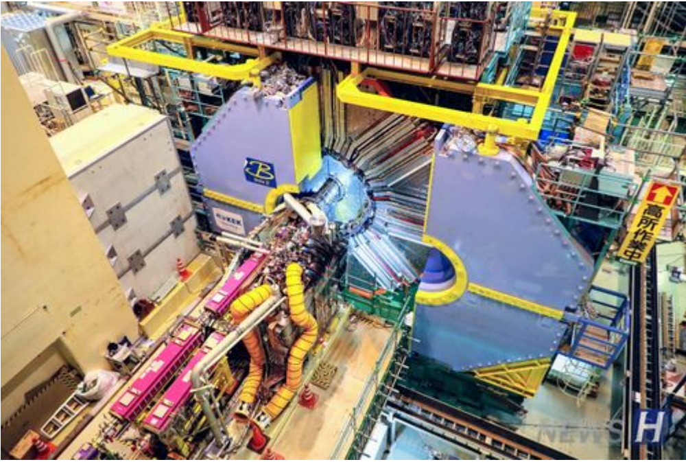
SuperKEKB 가속기의 전자-양전자 충돌지점 내부 모습. 충돌지점 주위로 물리사건에서 발생하는 다양한 입자들을 검출하기 위해 Belle II 검출기가 설치되어 있다.
