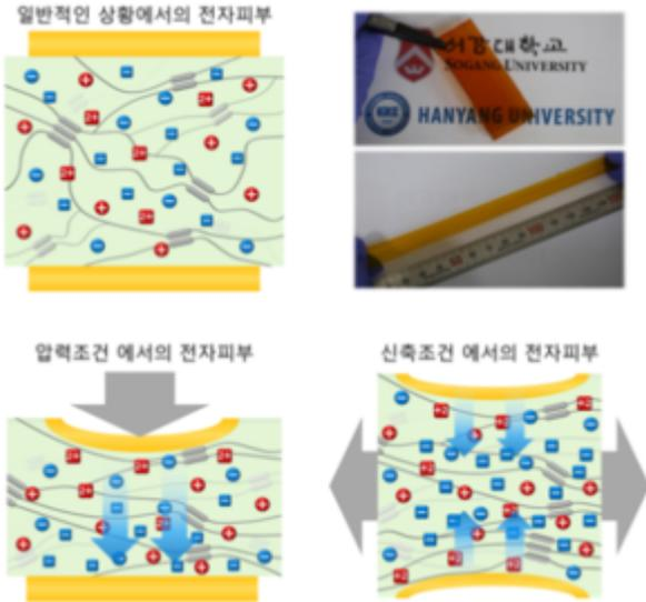
압력(그림 아래의 왼쪽) 및 인장(그림 아래의 오른쪽)에 의한 고분자 나노구조의 유변학적 거동(점-유탄성)과 이때 발생하는 소재 내 이온 분포의 변화(압이온 효과)의 상호작용 작동원리(메커니즘)를 보여주는 모식도. 구성 이온의 이동도 차이에 의해 음이온이 상대적으로 빠르게 움직이고, 그 결과 형성되는 전하분포의 변화를 보여준다.
